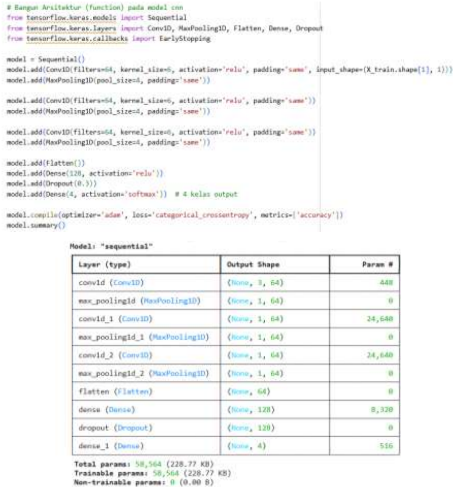
Gambar 10 Parameter Model CNN
