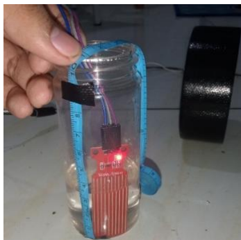
Gambar 16. Pengujian pada Ketinggian 30 mm
