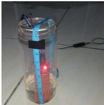
Gambar 15. Pengujian pada Ketinggian 20 mm
