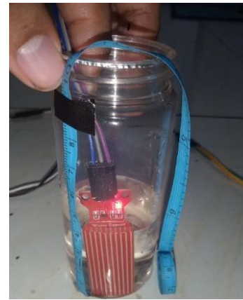
Gambar 17. Pengujian pada Ketinggian 40 mm
