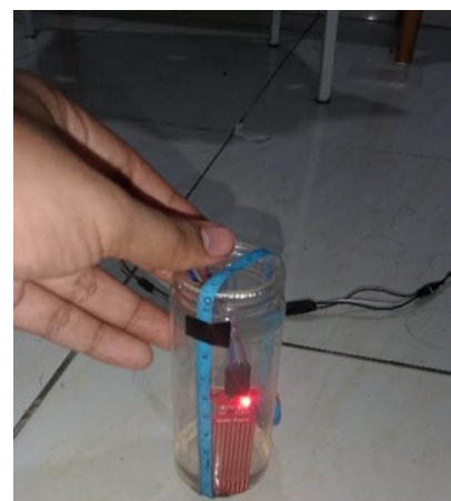
Gambar 14. Pengujian pada Ketinggian 10 mm
